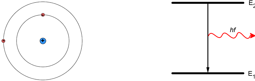
Abbildung 4.8: links: Darstellung des Bohrschen Atommodells, rechts: Darstellung der Bahnen als Energieniveaus mit den Niveaus 1 und 2.
