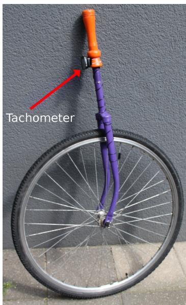
**Abb. 5:** Geschwindigkeitsmesser: Konstruktion zum Halten einer konstanten Geschwindigkeit und dem Erfassen der benötigten Zeit mit Hilfe des angebrachten Tachometers.
